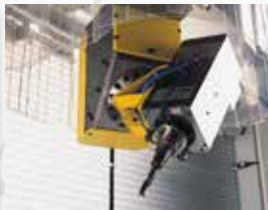
Frässpindel HSK F63 16 oder 26 kW
