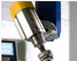
MAKA-Frässpindel HSK F63 16 oder 26 kW
