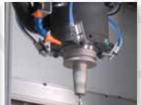
Minimalmengenschmierung Kühldüse am Aggregat
