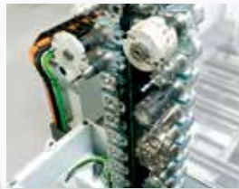
Ketten-Werkzeugmagazin mit 16 oder 32 Plätzen
