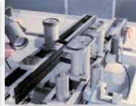
Traversentisch mit Vakuumpaket
