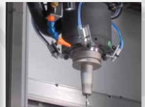
Minimalmengenschmierung, Kühl/Schmierdüse am Aggregat
