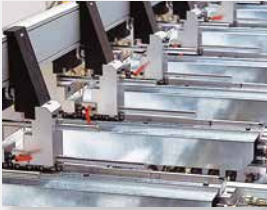
Maschinentisch mit 6-Stahl-Auflagetraversen
