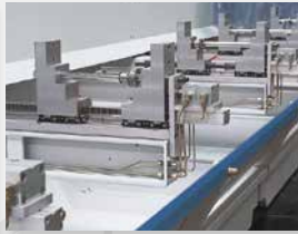
Hydraulische Profilstanze- einheiten, beidseitig öffnend
