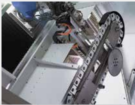
Ketten-Werkzeugmagazin mit 33 Plätzen
