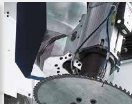
Standard-Fräsaggregat mit kardanischer Lagerung
