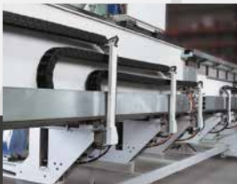
Spänegeschützte Versorgungs- leitungen auf der Rückseite
